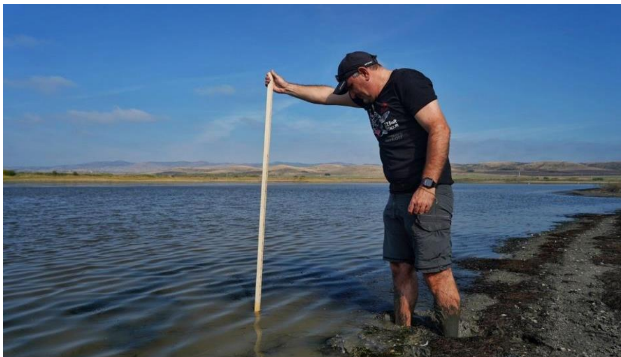
Фиг. 8 Измерване на дълбочина в местообитание 1150* с използване на лата
