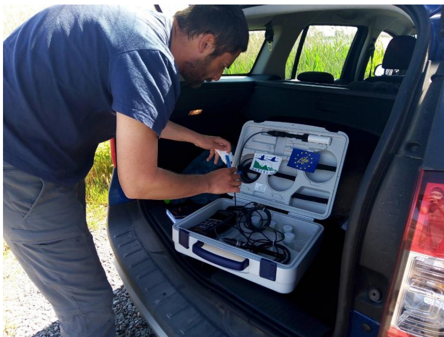
Фиг. 9 Измерване на кислородното насищане и други физико-химични показатели
